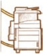
・しっかり固定するには機器の取付箇所、機器全体上下接合部の強度が必要。
